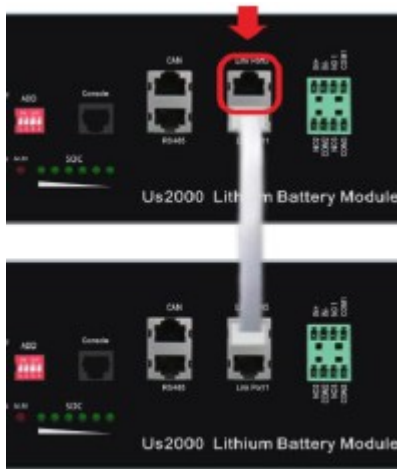
Abbildung 9: Nicht belegter „Link Port 0“ = Mastermodul
